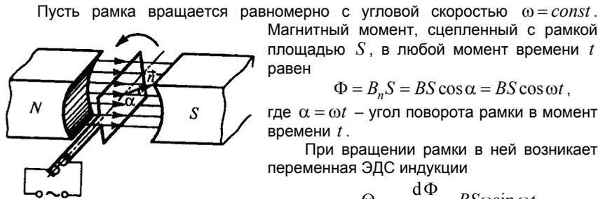
Пусть рамка вращается равномерно с угловой скоростью  $\omega = const$ .
